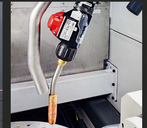
WAAM (mit Draht und Lichtbogen)
